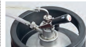
Testa di spillatura per spinone a baionetta in servizio (in alto), fuori servizio (in basso)
